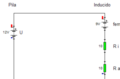
Ilustración 18: Malla de un motor de c.c. con resistencia de arranque
